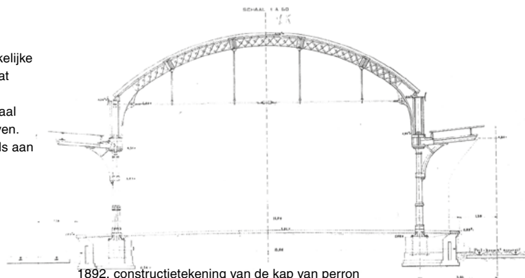
1892, constructietekening van de kap van perron 2/3. [RAN]
