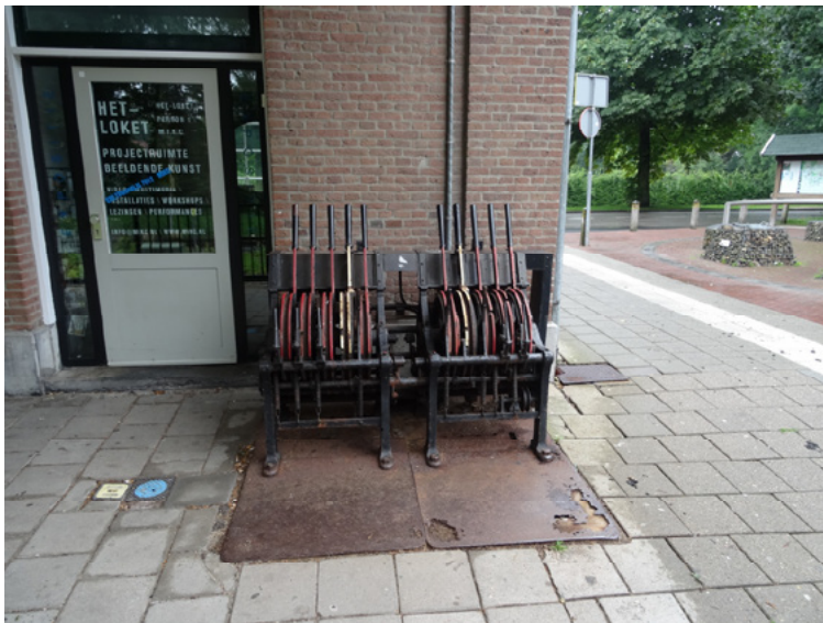
Afb. 4.12 Het handmatige bedieningspaneel voor de baanvakbeveiliging Laren-Delden.
